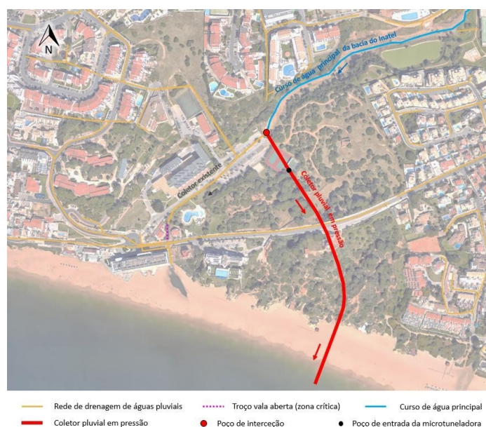
Figura 3.5-14 - Traçado em planta do coletor pluvial em pressão proposto, na bacia do Inatel
