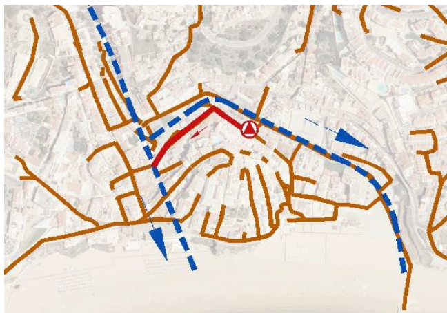
Figura 3.5-6 - Representação esquemática do sistema elevatório da Rua Cândido dos Reis
