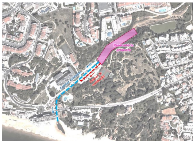
Figura 3.5-4 - Representação esquemática, em planta, do reservatório enterrado na bacia do Inatel
