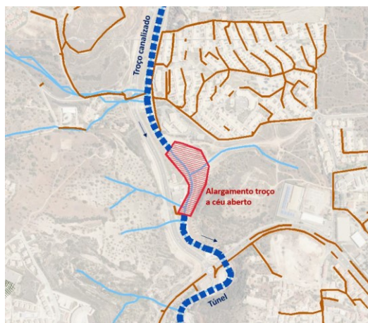
Figura 3.5-5 - Representação esquemática da ampliação da bacia de retenção do parque urbano
